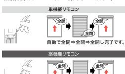
[設定完了確認] 6 【とじるボタン】を1回押して閉作動をすれば 完了しています。
