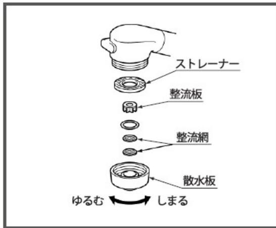
1 整流網・整流板の紛失を防ぐため、洗面器の排水栓を閉じます。
