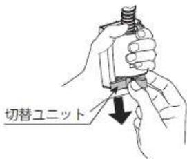
※切替ユニットが固くて外しにくい場合は、ゴム手袋や軍手、布などで掴み、回転させずに引き抜いて外してください。無理に回転させると切替ユニットが破損する恐れがあります。
