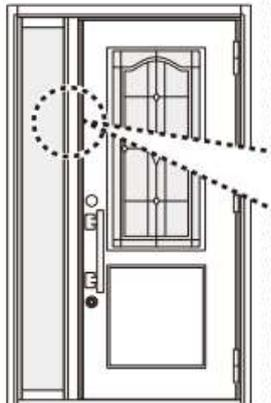
※マグネットの取付けねじをゆるめる（1～2回まわす）と内外方向、上下方向にマグネットを調整できます。
