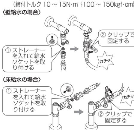
※ 取付け後にクリップを回し、確実にハマっていることを確認してください。また、給水ホースを軽く引き、確実に接続されていることを確認してください。
