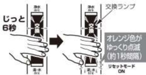
3. 浄水センサーに約6秒手をかざし続け、リセットします。
