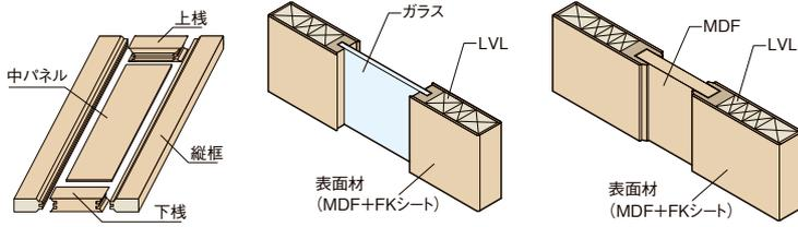
木質系素材を使用した枠を組み合わせた構造。
